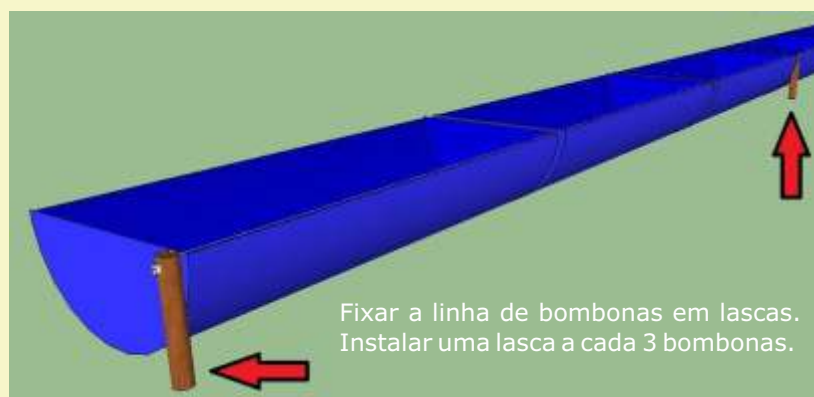
Figura 5. Instalação das lascas a cada 3 bombonas.
